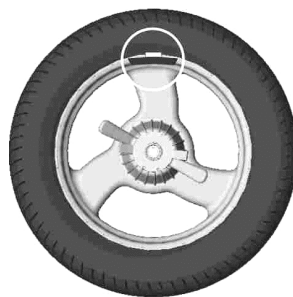
Рисунок 6.6 - Груз установлен в «12 часов»
