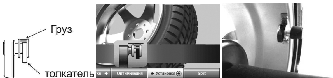
Рисунок 5.13 – Установка груза линейкой
