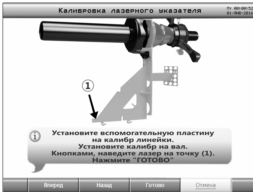
Рисунок 8.7 – Окно калибровки лазерного указателя
