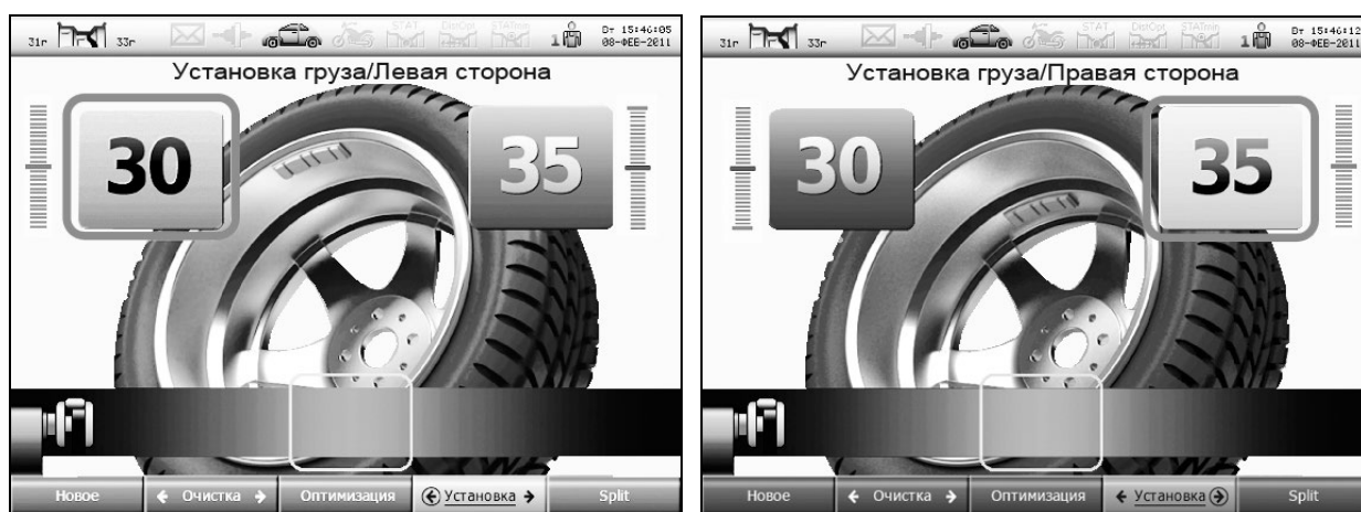
Рисунок 6.11 – Схемы установки грузов
