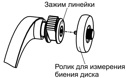
Рисунок 7.5 – Ролик для измерения биений
